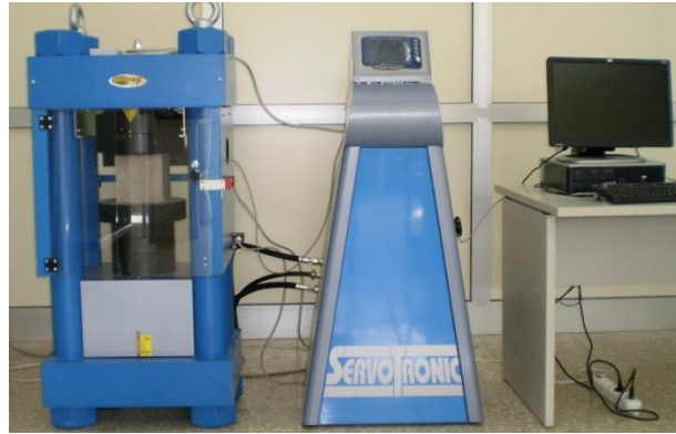
Pressa 3000 kN ad alta stabilità (prove su calcestruzzi).
