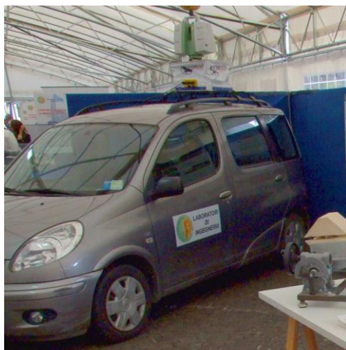
Strumentazione per rilevamenti topografici in modalità SCAN&GO
