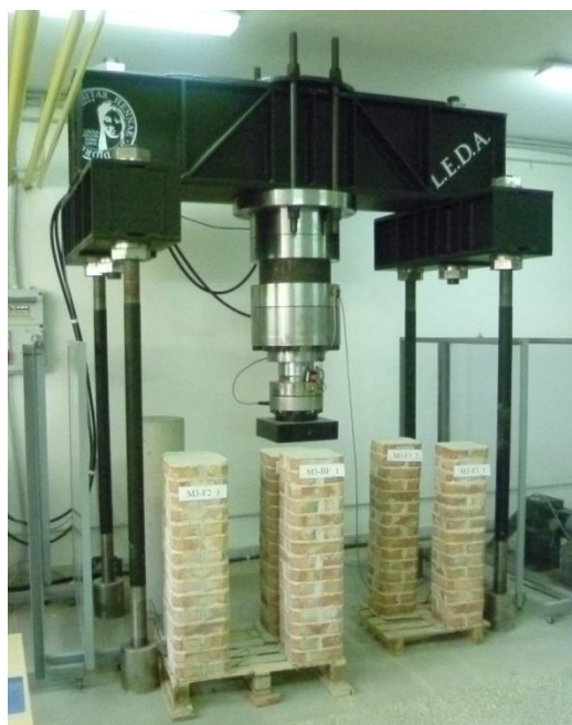
Telaio di reazione con attuatore idraulico da 2000 kN (prove statiche su elementi strutturali).
