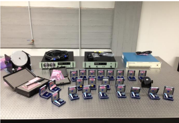
Figura 2 - Set di sensori piezoelettrici, martelli strumentati e shaker modali.
