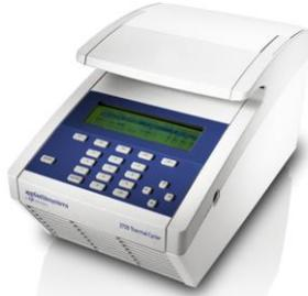
Il **Termociclatore** è in grado di condurre automaticamente le determinate variazioni cicliche di temperatura necessarie all'amplificazione enzimatica di sequenze di DNA in vitro attraverso la reazione a catena della polimerasi (PCR). La PCR è una delle più diffuse metodiche della moderna biologia, tramite essa è possibile amplificare rapidamente una piccolissima quantità iniziale di DNA a scopo di analisi o ricerca scientifica.
