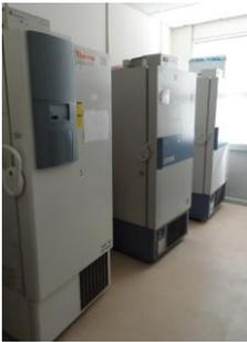
Tutti gli apparecchi, attraverso sonde specifiche montate all'interno, sono monitorati con **controllo remoto**, per cui in caso di guasto o di anomalie si attiva un allarme in Control Room (presidiata 24 h su 24); gli operatori comunicano l'allarme al rispettivo proprietario. È in progetto di attivare nei prossimi mesi una **Camera Fredda (+4°C)** per la conservazione di reagenti e per esperimenti da effettuare a freddo, nel locale destinato a questo scopo al piano 1.
