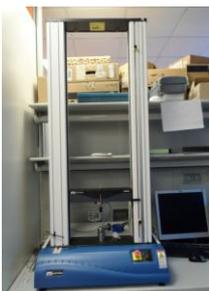
La **Macchina per prove meccaniche** consente di effettuare una varietà di prove meccaniche sui materiali (trazione, compressione, rilassamento dello sforzo, ecc.). Nella sua attuale configurazione, la macchina è dotata di 2 celle di carico (con fondo scala rispettivamente di 10 N e 500 N).
