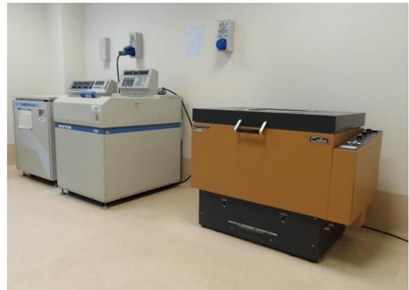
Supercentrifughe e Incubatore oscillante termostato per la crescita omogenea in terreno di coltura a temperatura controllata
