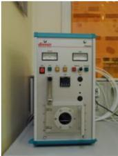
Il **Plasma Cleaner** consente la pulizia dei substrati litografici mediante ossigeno in fase plasma. Può essere utilizzato inoltre per l'attivazione delle superfici (es. vetro e PDMS) che vengono rese fortemente idrofiliche in seguito al processo al plasma. La superficie del componente è fisicamente pulita da un bombardamento ionico. La contaminazione viene convertita nella sua fase gassosa ed eliminata.
