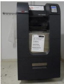
La **stampante 3D** permette di avere una riproduzione reale di un modello realizzato con un software di modellazione a 3 dimensioni. Inoltre essa è considerata una forma di produzione additiva mediante cui vengono creati oggetti tridimensionali da strati di materiali successivi.
