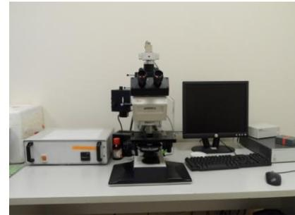
*Microscopio rovesciato a fluorescenza Leica (Leitz DMRB)*
