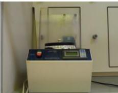
Lo **Spin Coater** consente la deposizione di film su substrati mantenuti in rotazione, a partire da soluzioni o sospensioni in solventi acquosi e/o organici. In particolare, l'apparecchiatura è utilizzata nei processi litografici per la deposizione di film di fotoresist a spessore costante.
