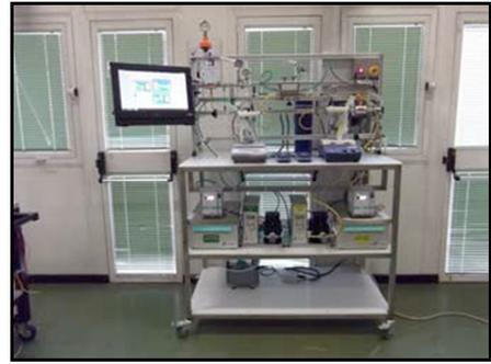
Impianto per la produzione di membrane polimeriche tubolari cave a temperatura media realizzato per i seguenti laboratori di ricerca:
